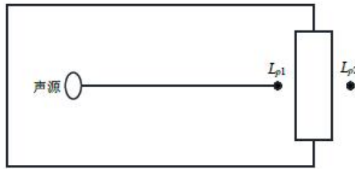
图 4-1 室内声源等效为室外声源图例
